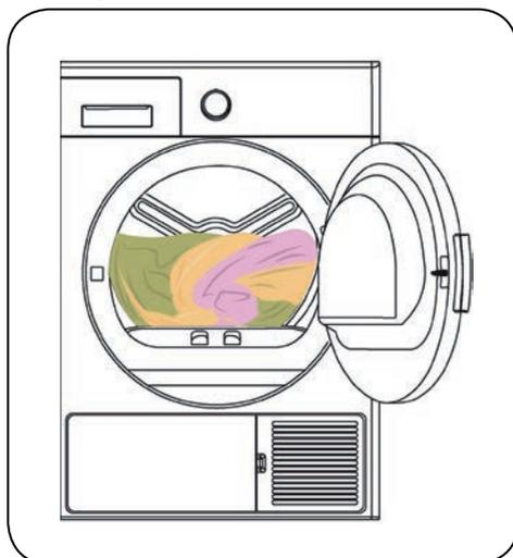
**WICHTIGE BEMERKUNG:** Der Trockner sollte gemäß Bild beladen werden. Überschreiten Sie nicht die angeführte Wäschemenge. Wird der Trockner überlastet, geht seine Leistung zurück. Darüber hinaus könnten Trockner und Wäsche beschädigt werden.
